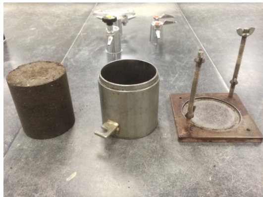
(d) Sample and mold after extrusion
