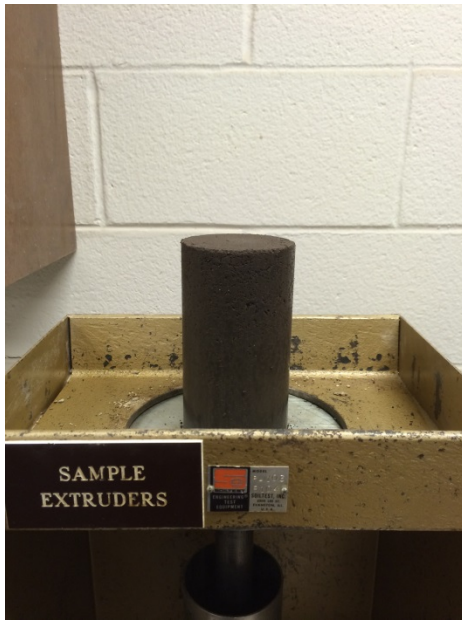
(d) Soil specimen extrusion
