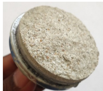
(d) Failure Mode G in sample 4
