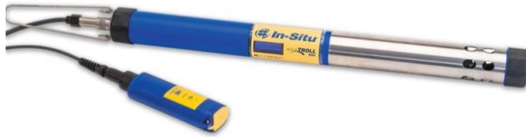
Fig 3.6 Aqua TROLL 600 Multiparameter Sonde
