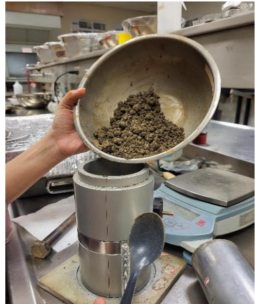
(d) Pouring of soil in the mold
